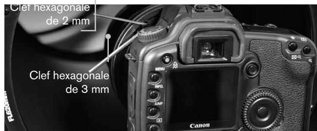
7. Si le motif en étoile est fin d'un côté, ajustez les vis de collimation pour que l'étoile se déplace vers le côté fin, puis ajustez la position de l'astrographe pour recentrer l'étoile. Répétez ces étapes jusqu'à ce que l'image de l'étoile soit concentrique.
