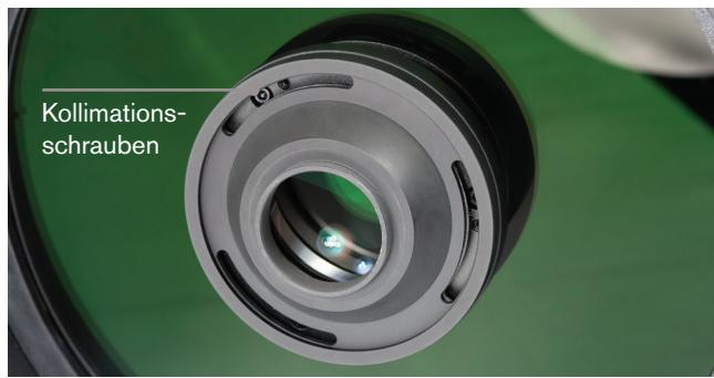
3. Richten Sie den Astrographen auf Sie einen hellen Stern und stellen Sie die Kamera scharf. Zentrieren Sie den Stern im Sichtfeld der Kamera. Verwenden Sie nach Möglichkeit den Polarstern, da dieser sich im Laufe der Zeit nicht viel bewegt.
