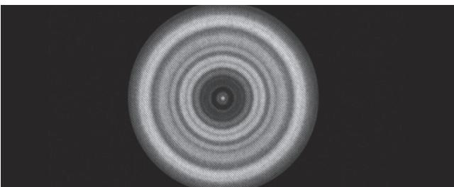
6. Tiene tres pares de tornillos de colimado. Cada par funciona conjuntamente como un ajuste de empuje-inclinación. Ajuste el colimado aflojando y apretando uno de los pares de tornillos de colimado. Afloje siempre uno de los tornillos primero y apriete a continuación el otro. Ajuste un par de tornillos cada vez.
